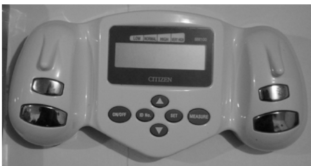
Figura 3. Medidor de grasa corporal marca CITIZEN modelo BM100 utilizado para determinar el porcentaje de grasa corporal por análisis de impedancia bioeléctrica. Fuente: Directa.
