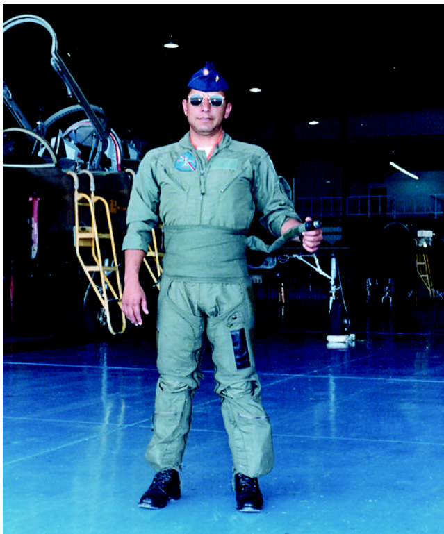
Figura 2. Se observa el traje anti "G" tipo usaf-standard, donde se muestra el dispositivo mediante el cual se conecta a la nave para su funcionamiento.
