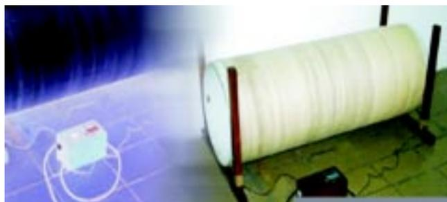
**Figura 2.** Dispositivo generador de campos electromagnéticos de frecuencia industrial para uso en animales pequeños de laboratorio. Este dispositivo fue diseñado y fabricado en el Departamento de Informática de la Escuela Superior de Medicina del Instituto Politécnico Nacional (ESMIPN) y utilizado en el bioterio de la Escuela Médico Militar (EMM) perteneciente a la Rectoría de la Universidad del Ejército y Fuerza Aérea (UDEFA).
