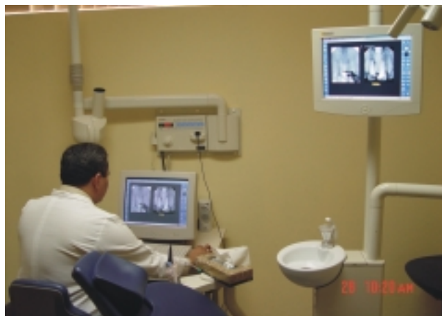
Figura 2. Impresión digital que es manipulada por el Cirujano Dentista en su cubículo, como son filtros de luminosidad o contraste, la representación ampliada, así como la medición de longitudes y ángulos.
