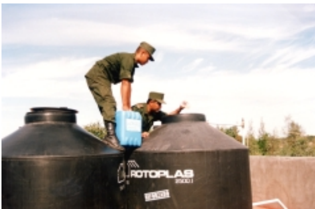
Figura 2. Determinación de cloro residual y pH en tanques de distribución de agua potable en campos militares.
