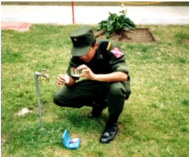
Figura 1. Verificación de cloro residual y pH en el agua potable de la red municipal.
